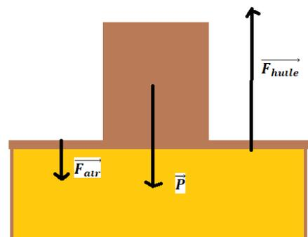
Le système est immobile ce qui signifie d'après le principe d'inertie que les forces se compensent.
